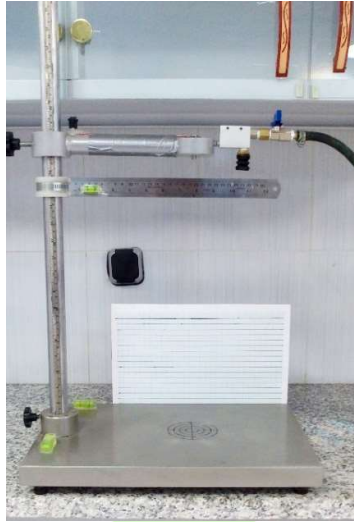
شکل ۲. سامانه‌ی سقوط آزاد به همراه پس زمینه کالیبراسیون ارتفاع بازگشت
