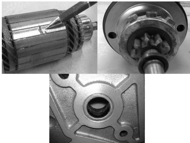
شکل ۳- خرابی های موتور استارت: ترک در بدنه روتور (بالا - چپ)، نابالانسی محور محرک (بالا- راست)، سایش در یاتاقان انتهایی (پایین)
