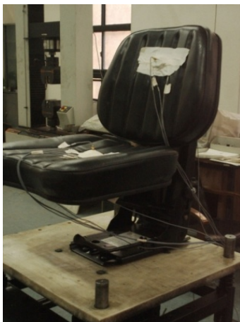
شکل ۴. صندلی تراکتور مدل ۲۸۵ نصب شده روی فیکسچر
