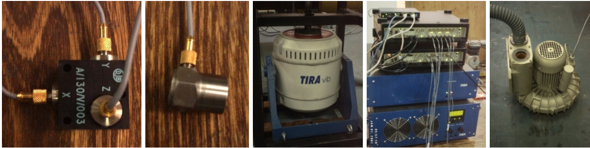
شکل ۵. قسمت‌های مختلف دستگاه اندازه‌گیری ارتعاش و ثبت آن. به ترتیب از راست به چپ: شتاب‌سنج سه جهتی، شتاب‌سنج یک جهتی، دستگاه لرزاننده، تقویت‌کننده و کمپرسور هوا
