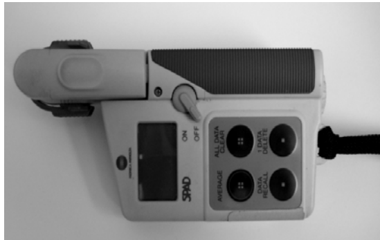
شکل ۴- کلروفیل متر spad502 ساخت شرکت Konica Minolta استفاده شده در آزمایش
