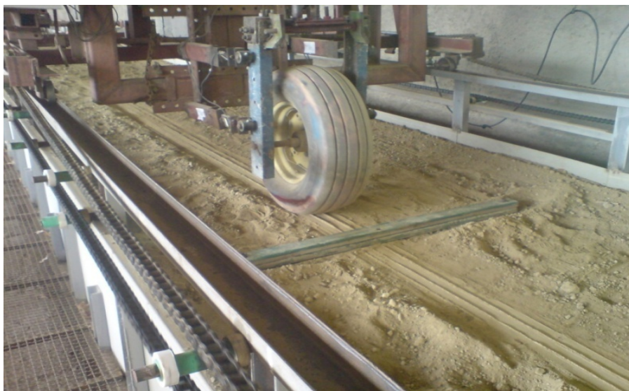
شکل ۴: حرکت چرخ از روی مانع طی آزمایشات انجام شده در سویل بین
