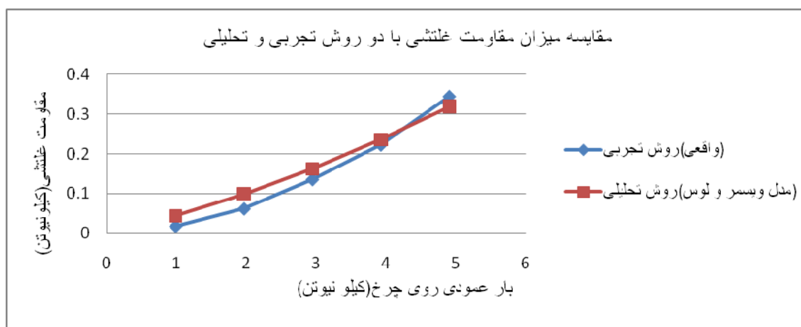
شکل ۱۲: مقایسه مقاومت غلتشی چرخ با استفاده از دو روش عملی و تحلیلی
