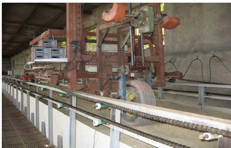
شکل ۴ تصویری از آزمونگر تک چرخ سویل بین مورد استفاده در این آزمایشات را نمایش داده است.
