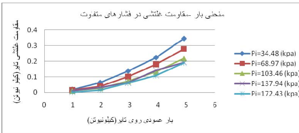
شکل ۱۰: رابطه بار عمودی روی تایر و مقاومت غلتشی چرخ
