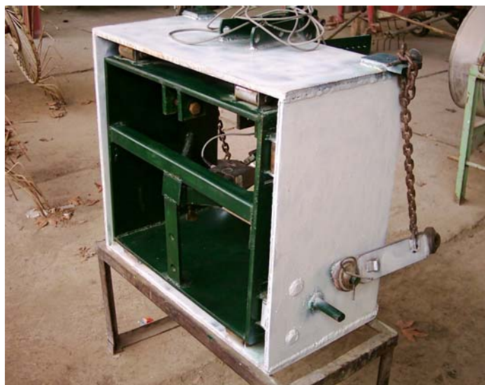
شکل ۲- دینامومتر اتصال سه نقطه ابداعی
