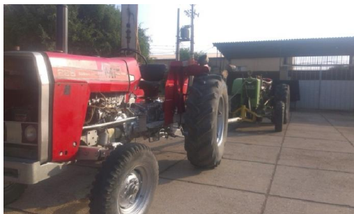
شکل ۶: تراکتور مورد آزمون و نحوه اتصال آن به تراکتور بارگذار
