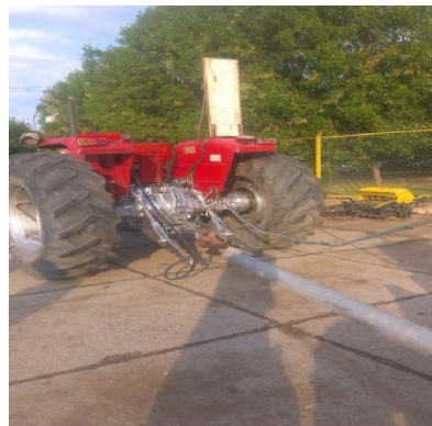
شکل ۲: نحوه اتصال دو تراکتور توسط دینامومتر هیدرولیکی
