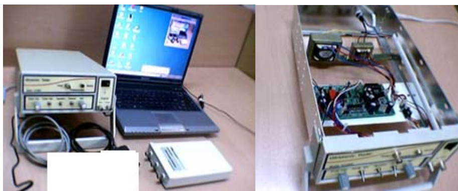
شکل ۱- قسمت‌های مختلف سامانه اندازه‌گیر خصوصیات فراصوتی خاک
