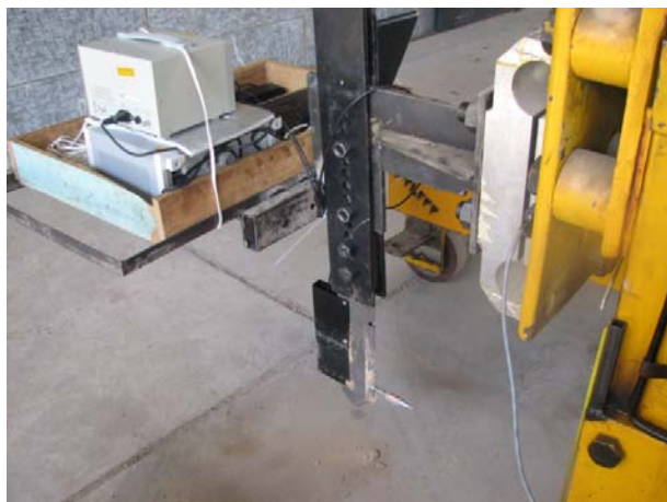
شکل ۴- نصب حسگر مرکب بر روی واحد کشنده مخزن خاک
