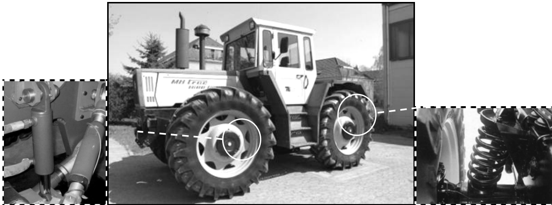
شکل ۱. تراکتور آزمایشی مجهز به فتربندی متداول در محور جلو و فتربندی هیدرونیوماتیک در محور عقب
