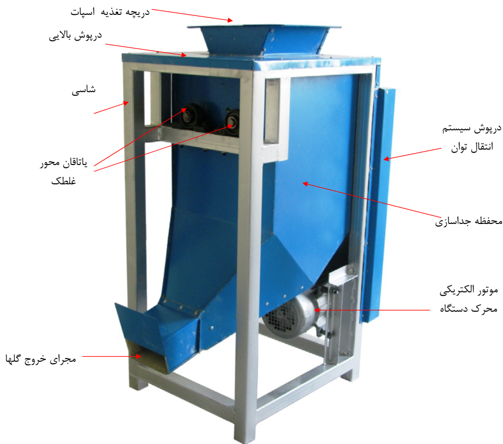
شکل ۲: نمای حقیقی واحد جداساز دستگاه جداساز گل‌های نر نخل خرما
