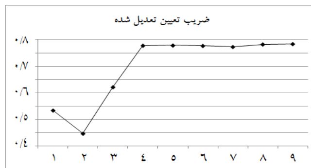
شکل ۴- ضریب تعیین تعدیل شده هر یک از نه مدل پیشنهاد شده برای تخمین نیروی کششی ابزار خاک‌ورز
