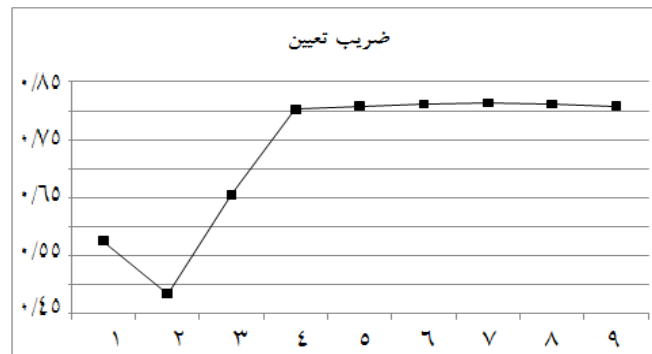
شکل ۳- ضریب تعیین هر یک از نه مدل پیشنهاد شده برای تخمین نیروی کششی ابزار خاک‌ورز
