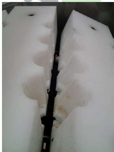
شکل ۲. نحوه باز شدن فنجانک‌ها در انتهای دستگاه
