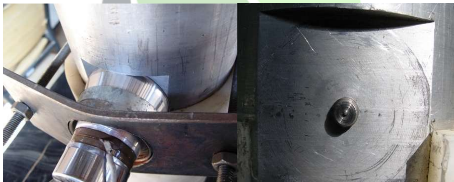
شکل ۴. محل تعبیه مبدل و نحوه اتصال آن
