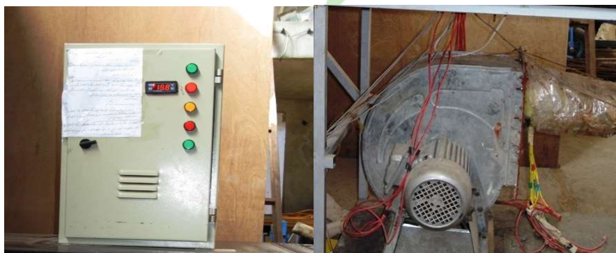
شکل ۱. الف- جعبه کنترل الکتریکی حاوی اینورتر، فیوزهای المنت، ترموستات ب- الکتروموتور به همراه فن و گرم کن
