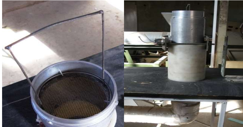
شکل ۵. الف- بستر توزین داخل محفظه خشک کن، ب-پروفیل تفلونی
