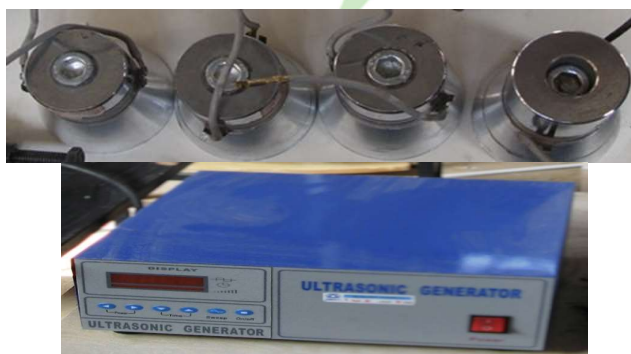
شکل ۳. ژنراتور به همراه چهار مبدل فراصوت توان بالا
