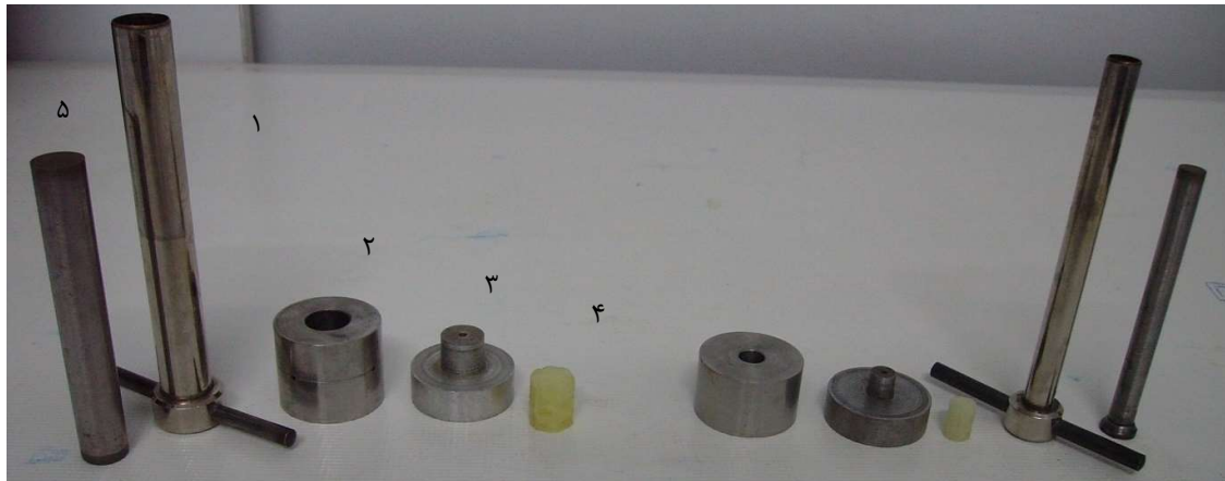
شکل ۱. وسایل آزمایش محصور و غیرمحصور برای قسمت گوشت (سمت راست) و قسمت دانه‌ها (سمت چپ). ۱) نمونه گیر ۲) استوانه‌ای محصور ۳) کفی جداشده ۴) نمونه و ۵) سنبه
