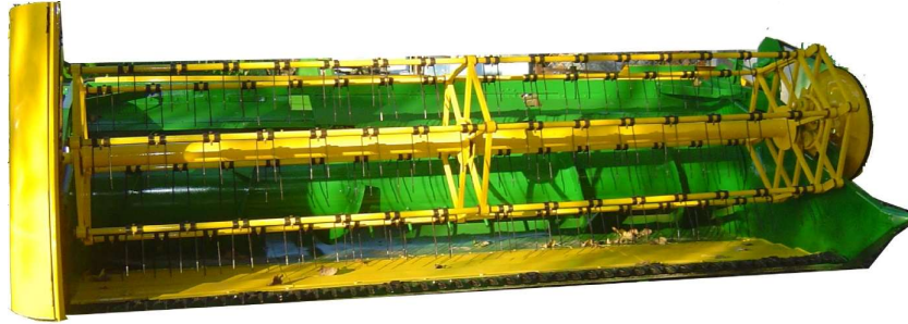
شکل ۱. هد مخصوص برداشت کلزا مدل RH-3600
