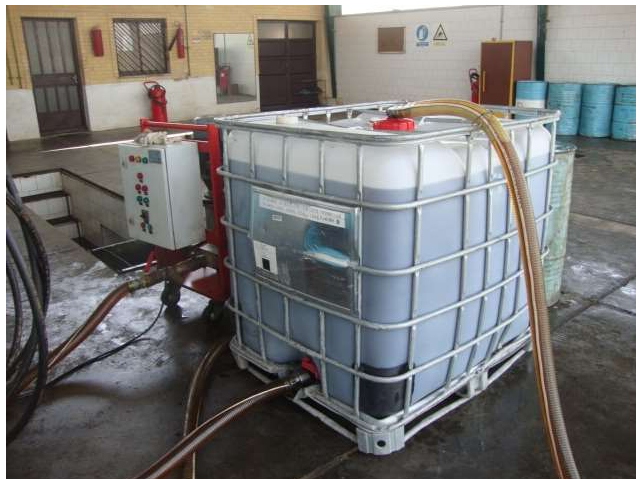
شکل ۲. دستگاه تصفیه روغن در حال تصفیه مخزن ۱۰۰۰ لیتری نگهداری روغن هیدرولیک دروگر نیشکر
