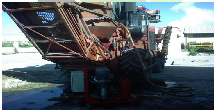
شکل ۱. دستگاه تصفیه روغن در حال انجام کار، بر روی مخزن هیدرولیک دروگر نیشکر
