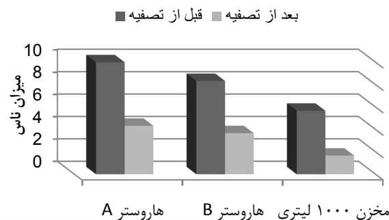
شکل ۳. میزان ناس اندازه گیری شده روغن هیدرولیک دروگر نیشکر قبل و بعد از تصفیه روغن
