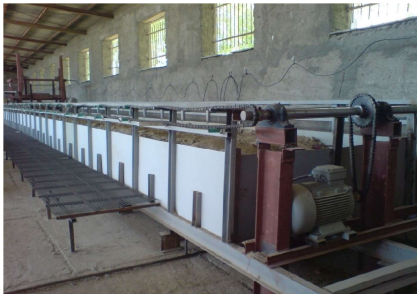
شکل ۱. سویل‌بین مورد استفاده از نوع ریل ثابت.
