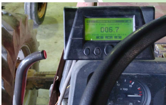
شکل ۲. حسگر و نمایشگر سوخت سنج دیجیتال حجمی نصب شده بر روی داشبورد تراکتور
