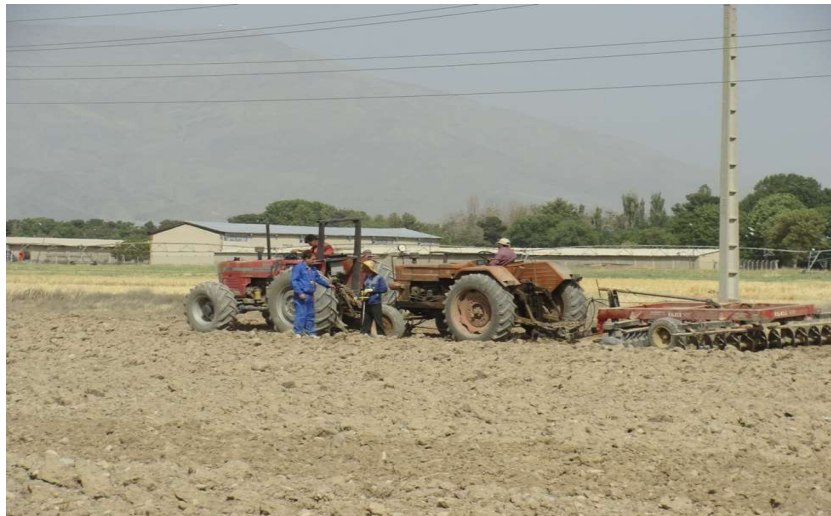
شکل ۱. تراکتور ITM399-4WD و تراکتور واسط متصل به تیروسنج و هرس بشقابی در حال آزمایش
