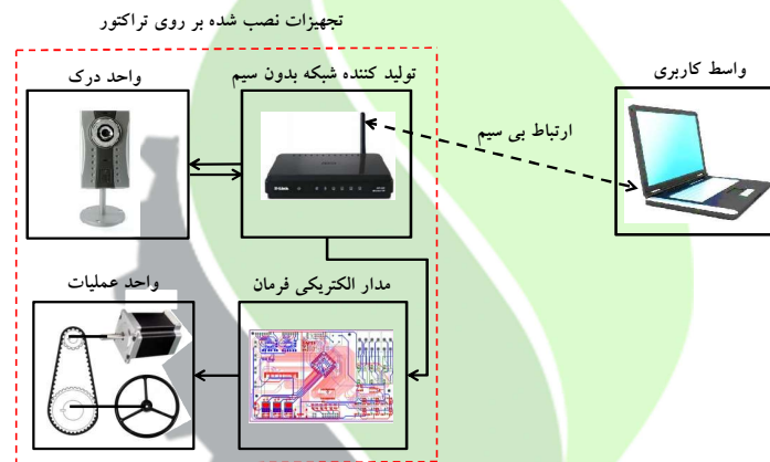
شکل ۱. نحوه ارتباط و تعامل واحدهای مختلف سامانه عملیات از راه دور تراکتور در این تحقیق
