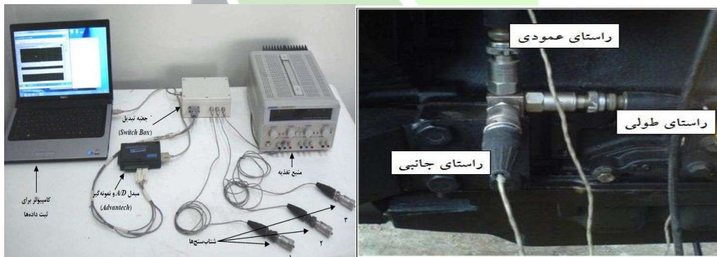
شکل ۲. نحوه اتصال شتاب‌سنج در قسمت جلوی موتور
