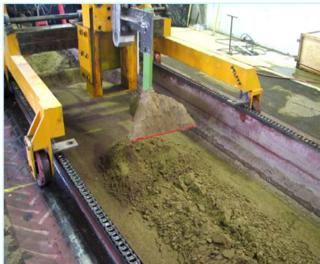
شکل ۱- تیغه خاک‌ورز بالدار تحت تست کشش در مخزن خاک
