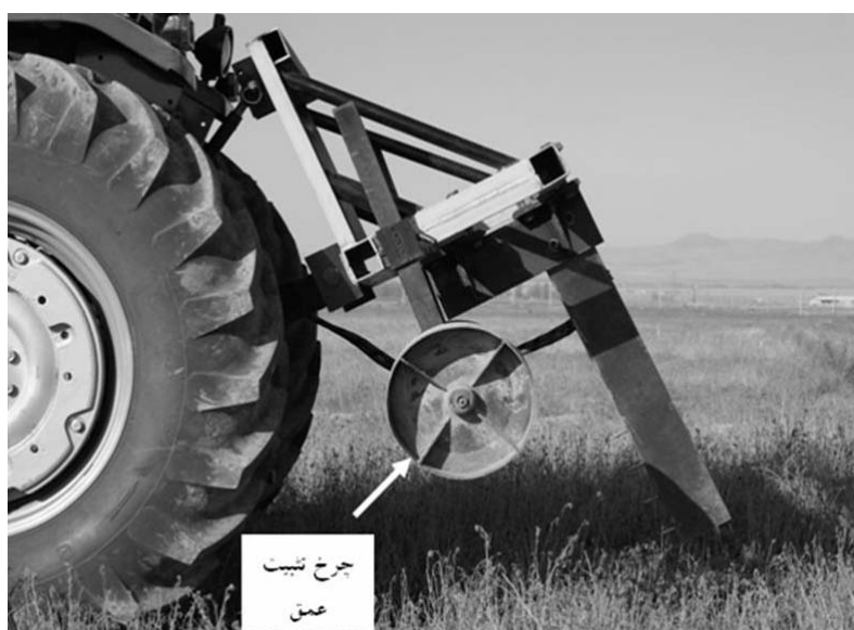
شکل ۳- دستگاه مقاومت مکانیکی پیوسته تک تیغه‌ای به همراه چرخ تثبیت عمق در حالت حمل و نقل
