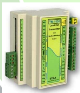
شکل ۲- ترنسمیتر استفاده شده برای واسنجی بارسنج.
