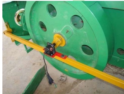
شکل ۵- نحوه اتصال شفت انکودر به چرخ لنگر بسته‌بند.
