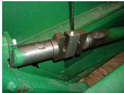
شکل ۱- بارسنج جایگذاری شده بر روی شاتون پلانتر بسته‌بند.
