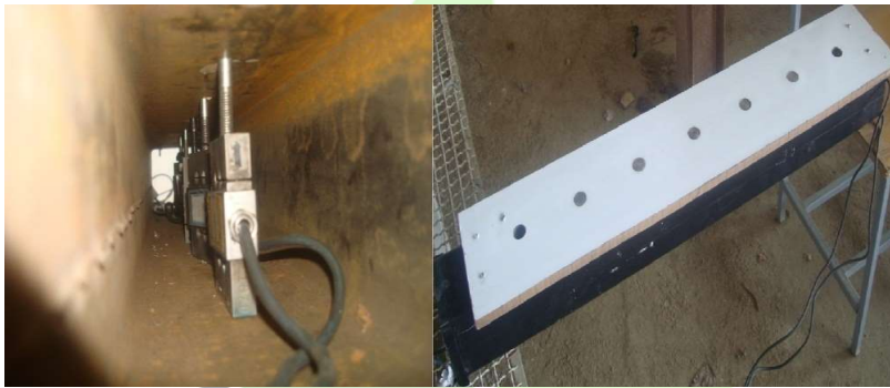
شکل ۲- سامانه اندازه‌گیری تنش زیر چرخ محرک با درپوش از جنس MDF با سوراخکاری‌های مورد نیاز برای نصب لودسل
