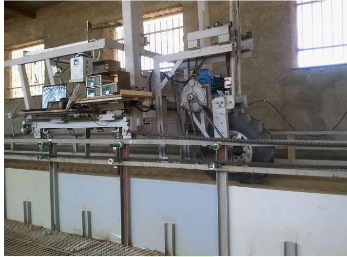
شکل ۱- شماتیکی از مجموعه‌ی انباره‌ی خاک و آزمونگر تک چرخ مورد استفاده در آزمایشات
