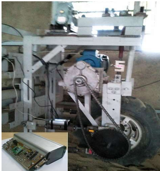
شکل ۱. شماتیکی از سیستم داده‌برداری و سامانه‌ی اندازه‌گیری نشست بصورت بلادرنگ
