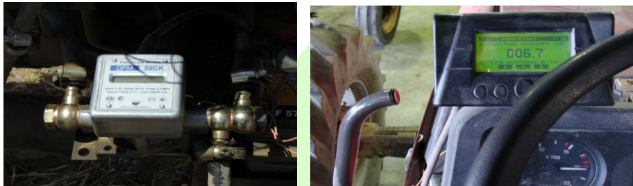
شکل ۲. حسگر و نمایشگر سوخت سنج دیجیتال حجمی استفاده شده در آزمایش
