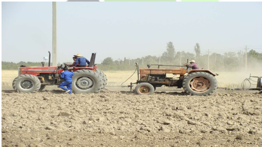
شکل ۱. تراکتور ITM399-4WD و تراکتور واسط متصل به نیروسنج و هرس بشقابی در حال آزمایش
