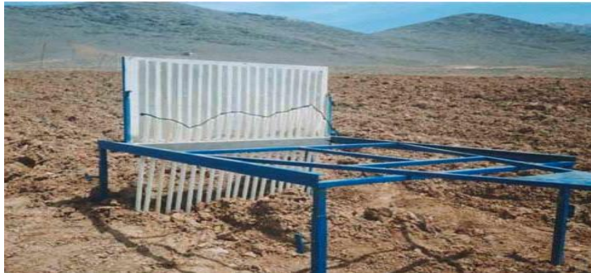
شکل ۶- دستگاه ناهمواری سنج نمونه سازی شده در دانشگاه شهر کرد
