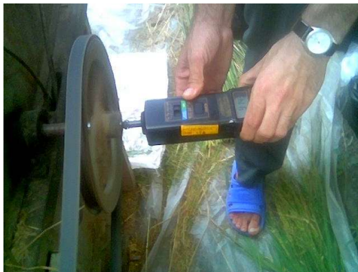
شکل ۱- نحوه اندازه گیری سرعت دورانی (rpm) محور کوبنده به کمک دورسنج دیجیتالی
