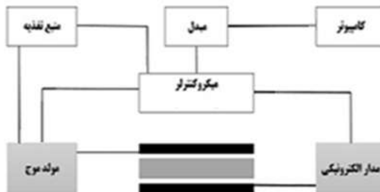
شکل ۱. مدار اندازه‌گیری و ثبت ولتاژ خروجی خازن
