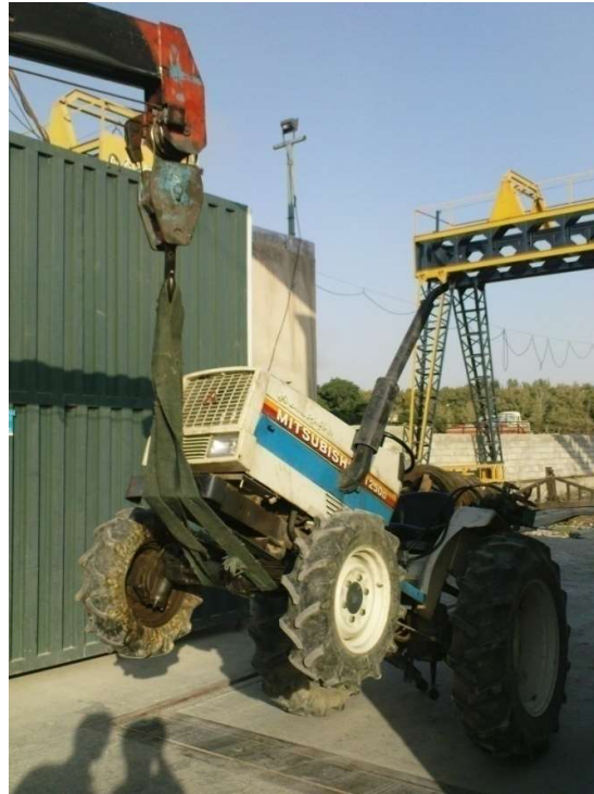
شکل ۲- بدست آوردن توزیع وزن در تراکتور
