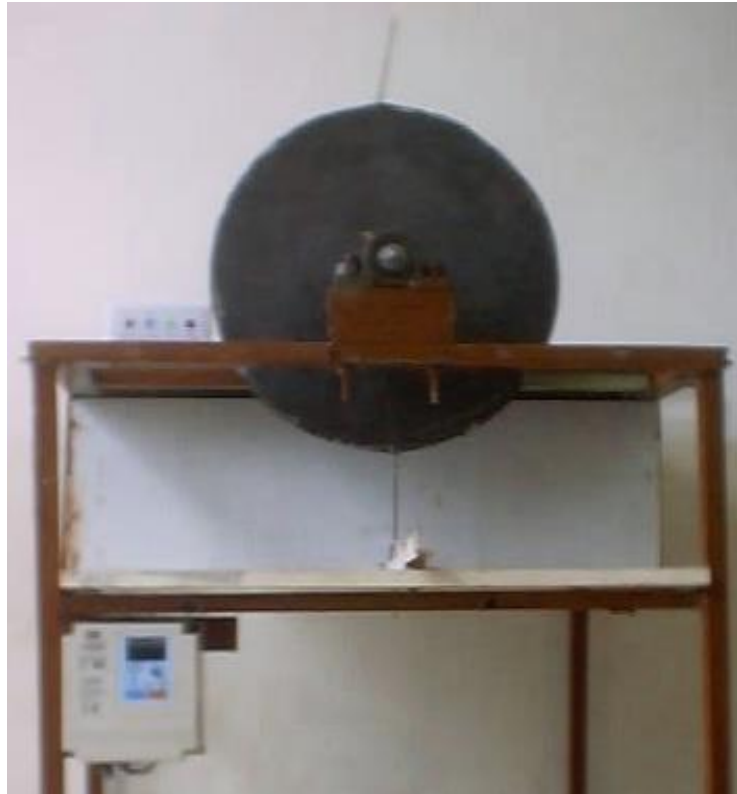
شکل (۱-ب) دستگاه بررسی اثر ضربه بر روی دانه ها (نمای روبرو)
