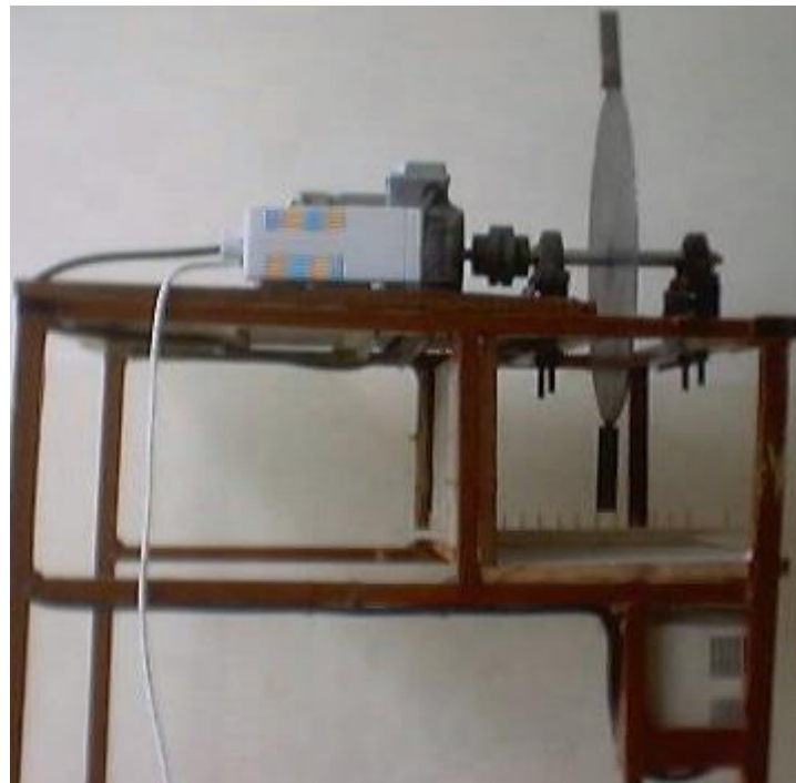
شکل (۱-پ). دستگاه بررسی اثر ضربه بر روی دانه ها (نمای کنار)
