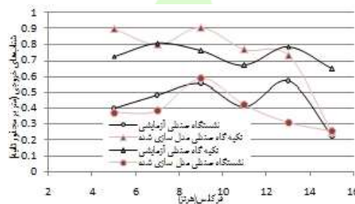
شکل ۱۱: نمودار شتاب‌های خروجی در شتاب تحریک ۲ متر بر مجذور ثانیه در قسمت‌های تکیه‌گاه و نشستگاه بدون فوم
