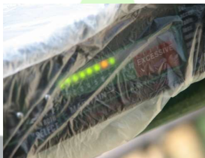
شکل ۲ - نمایش افت فرآوری با روشن شدن دیودهای نمایشگر تلفات دانه
