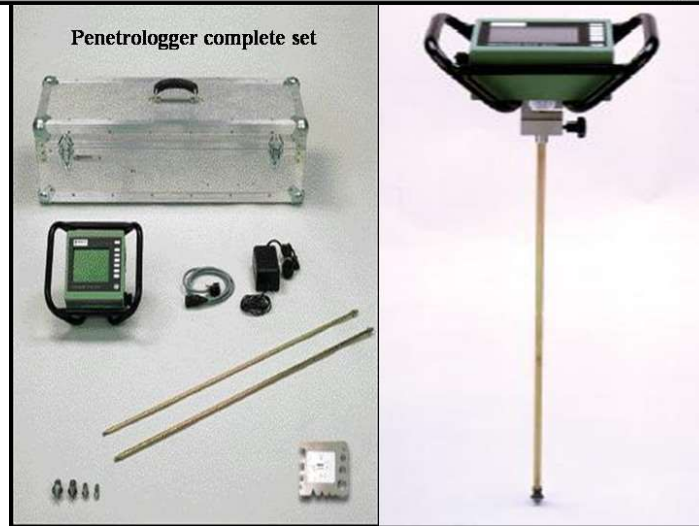
شکل ۱. دستگاه نفوذسنج مخروطی استفاده شده در تحقیق
