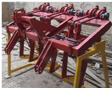
شکل ۱: نمونه واقعی ماشین چغندرکن ارتعاشی پیش از بهینه شدن
