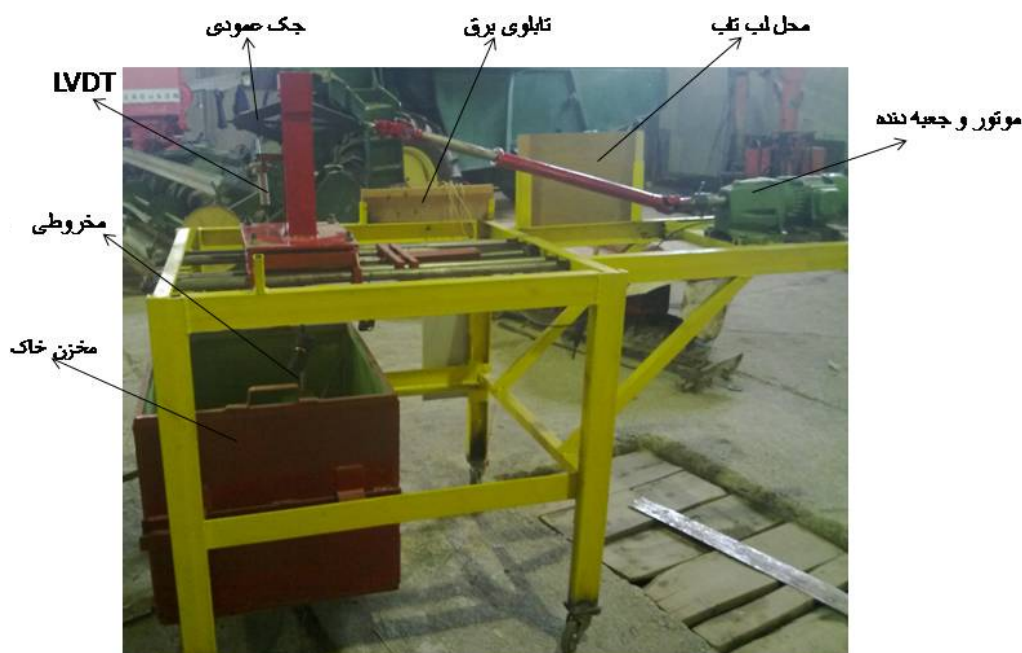
شکل ۴- طرح کلی دستگاه برای اندازه‌گیری نیروهای عمودی
