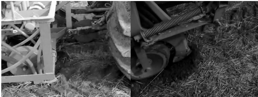
شکل ۸- سمت راست نمای محرکتشیار بازکن بذرکار آمازون در مزرعه، سمت چپ نمای محرکتشیار بازکن بذرکار آگرو رهینو در مزرعه.
