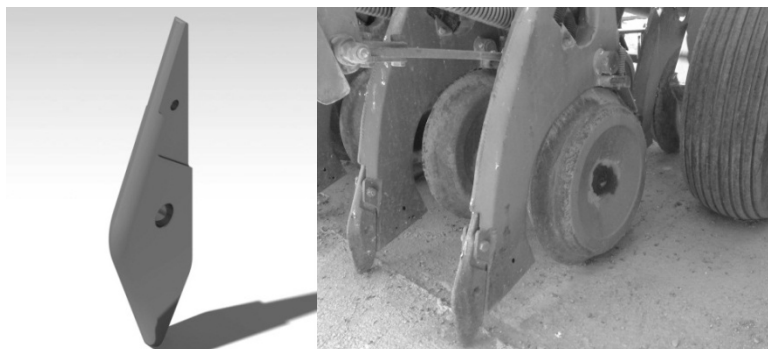
شکل ۳- سمت راست، نمای شیار بازکن بذرکار آمازون. سمت چپ، تصویر شبیه سازی شده شیار بازکن بذرکار آمازون.
