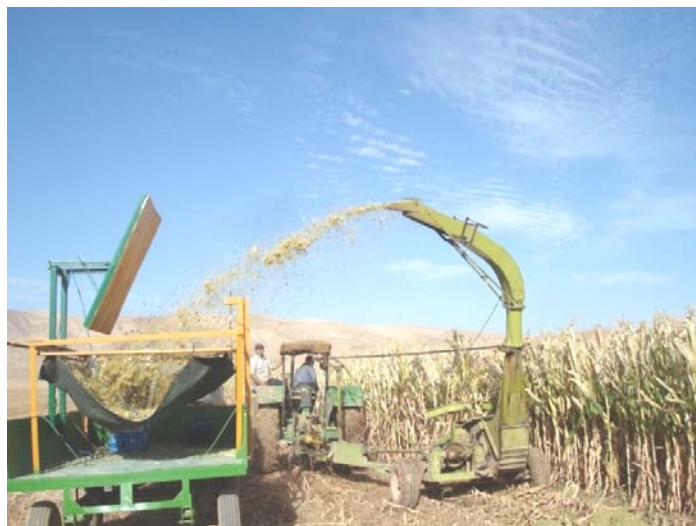
شکل (۱۲) آزمون نهایی مزرعه ای به کمک تریلی مجهز به سامانه توزین الکترونیکی
