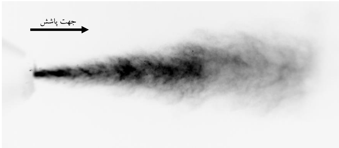
شکل (۵): تصویری از اسپری تولید شده توسط نازل دو سیاله القایی.
