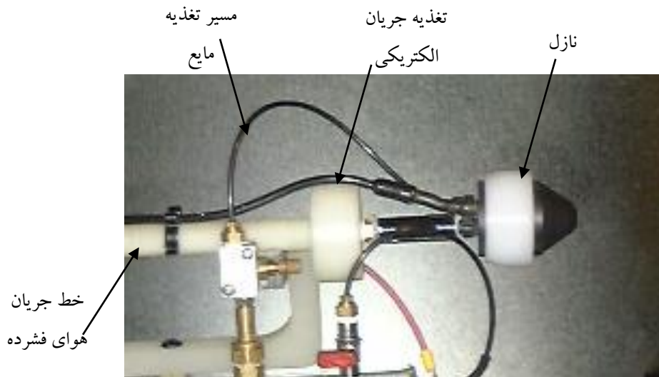
شکل (۳): تصویری از نازل دو سیاله القایی و خطوط جریان هوا، مایع و تغذیه الکتریکی.
