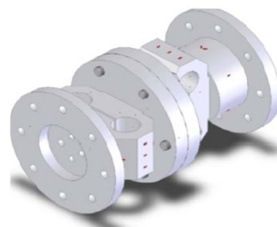
شکل ۵: موقعیت کرنش‌سنج‌ها بر روی واحد اندازه‌گیری نیرو و ممانها در دینامومتر سه محوره ادوات خاک‌ورزی
