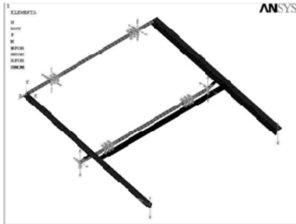
شکل ۲- ایجاد مدل مش بندی و اعمال بار روی مدل در نرم افزار Ansys.
