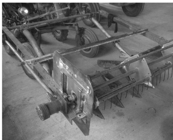
شکل ۶- نصب هیدروموتور به محور چرخ و فلک به وسیله کوپلینگ.
