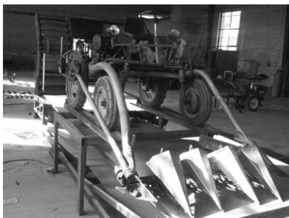
شکل ۱۰- نمایی از دستگاه یونجه چین چهار چرخ که بر روی تسمه نقاله قرار گرفته است
