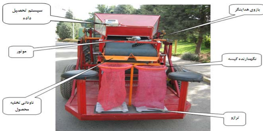
شکل ۱. مکانیزم توزین و کیسه کن نصب شده روی ماشین جمع آوری سیب زمینی
