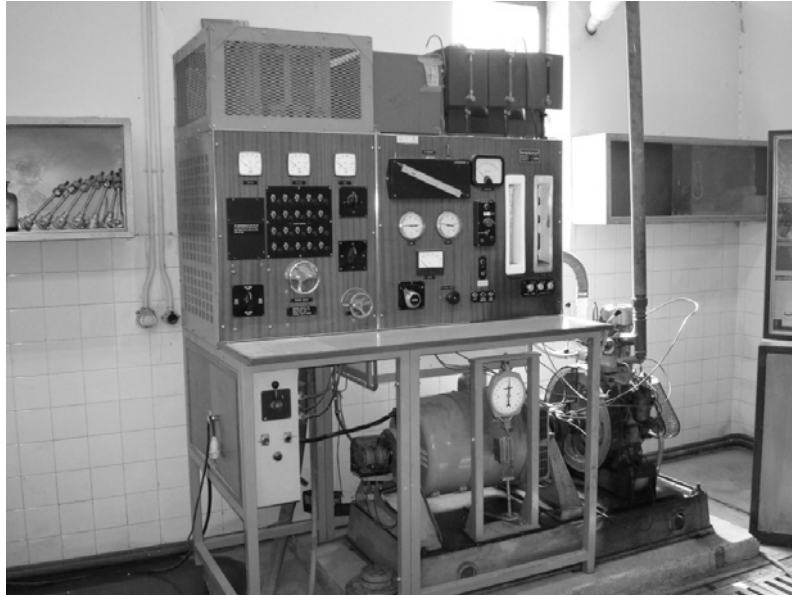
شکل (3). دینامومتر الکتریکی ساخت شرکت Tecquipment
