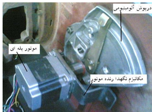
شکل ۶. موتور پله ای نصب شده روی تراکتور
