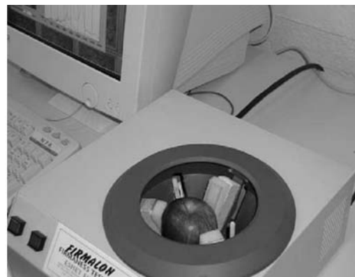
شکل ۹: دستگاه فیرمالون که توسط لایه پیزوالکتریک، پاسخ آکوستیک میوه‌ها را آشکار می‌کند
