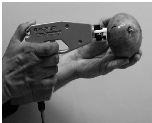
شکل ۱۱: مقایسه ارتباط بین شاخص استحکام میوه در دو روش آکوستیک میکروفن مبنا و روش لایه پیزوالکتریک، و دستگاه ساخته شده توسط Sugiyama
