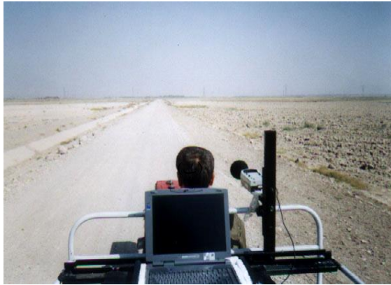
شکل ۱- الف - ابعاد ناحیه اندازه‌گیری صدا و ب - تراکتور دوچرخ و تجهیزات اندازه‌گیری صدا در موقعیت گوش راننده.
