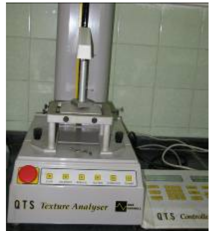
شکل ۳- دستگاه تست کشش - فشار اینسترون مورد استفاده در آزمایش
