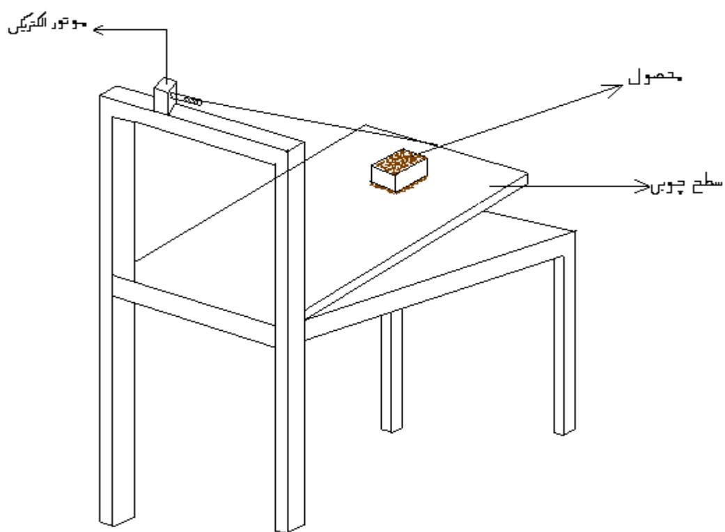
شکل ۱ - دستگاه اندازه‌گیری زاویه اصطکاک
